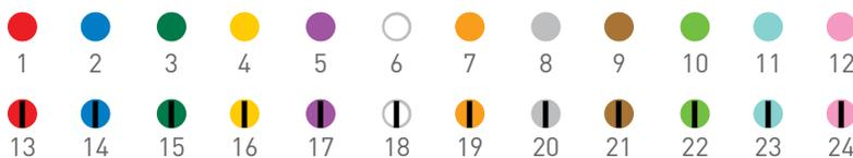
En el caso de cables con más de 12 módulos μSHEATH® se añaden al módulo una banda longitudinal de color negro o anillos radiales de color negro para facilitar la identificación. Hay más códigos de color para módulos y fibras disponibles bajo pedido.
